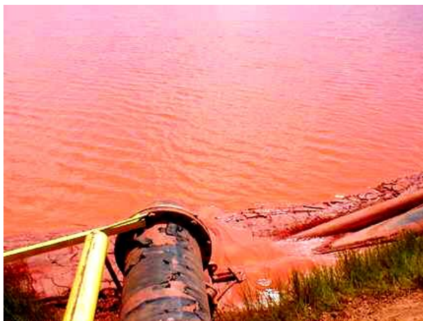
Слика 6. Искуства из тропских региона, где се иначе и налазе највећа налазишта боксита, показују да јаке атмосферске падавине могу веома да отежају исушивање базена у којима се одлаже црвени муљ
